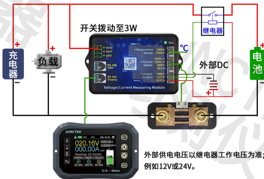
图 3-3-3 外部供电接继电器接线图
