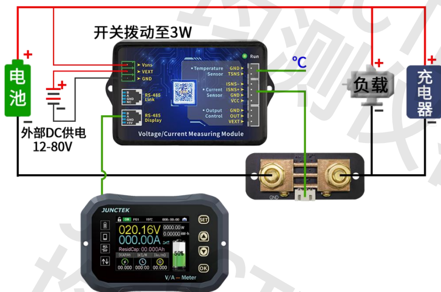
图 3-3-2 外部供电接线图
