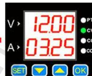
按 OK 键开启和关闭输出，当负载电流小于设定电流时，输出为恒压输出，CV 灯亮
