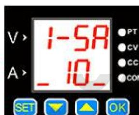
长按 **SET** 键进入电压电流上下限保存界面，通过 **△** 或 **□** 键改变子选项，10 代表当前电压电流值设置为上限、11 表示设置为下限、12 表示取消上下限，此界面按 **OK** 键，设置成功。
