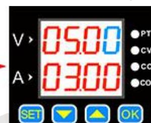
连续短按 SET 键闪烁位会在电压电流的不同位移动
