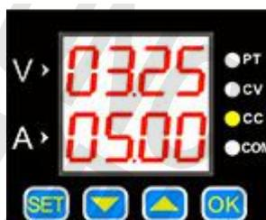
当负载电流达到设定电流时，输出为设定电流，恒流输出，CC 灯亮
