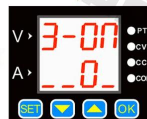
短按 **SET** 键进入上电默认输出状态界面，通过 **△** 或 **□** 键改变子选项，0 表示“关闭”、1 表示“开启”，然后按 **OK** 键，设置成功。
